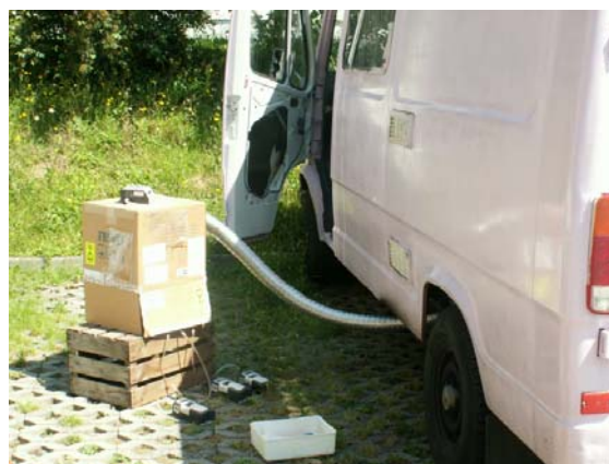
Illustration 33 : Installation permettant la collecte de particules diesel fraîches dans le cadre de la mise au point des mesures de réactivité de particules prélevées sur filtre (Source : IST)
